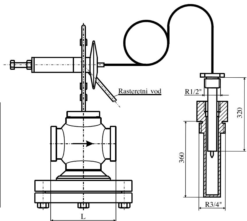
RT - N je regulator temperature sa servo upravljanjem. Ulogu pilot ventila ima regulacioni ventil tip T2 koji je sastavni deo ventila. Ventil se isporučuje zajedno sa zaštitnim priključkom za sondu (džep za termosondu). U zavisnosti od zahteva korisnika ovaj ventil može raditi u grejnom režimu kada kroz ventil protiče vodena para, ili u rashladnom režimu kada kroz ventil protiče voda. Ventil se isporučuje sa 1500 mm dugom impulsnom cevi.
