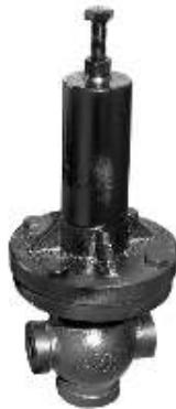
RVD - N je modifikovani ventil tip RVD namenjen za regulaciju pritiska ispod 2,5 bar. Osnovne karakteristike su mu identične ventilu RVD, jedina razlika je u veličini membrana. Ventil RVD - N ima membrane veće nego u RVD-a. Namjenjen je za regulaciju pritiska pare, vazduha ili vode. Proizvodimo ga sa navojnim priključcima od R1/2" do R6/4" i za nazivne pritiske od PN 16 do PN 25.
